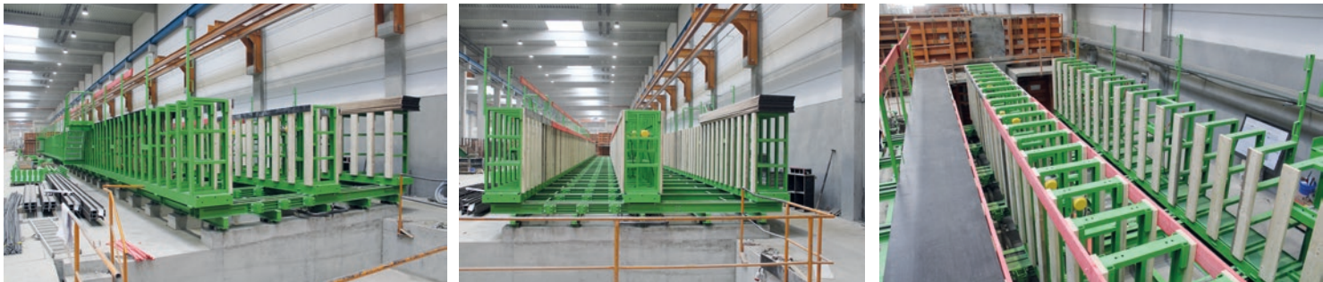
Multifunktionale Stabteilschalung dient zur Herstellung von Stützen mit Konsolen und sonstigen stabförmigen Bauteilen.
