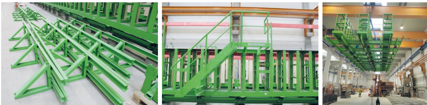
Als Baukasten-System konzipiert, kann das modulare Universal-Schalsystem für den jeweils benötigten Zweck umgebaut werden.
